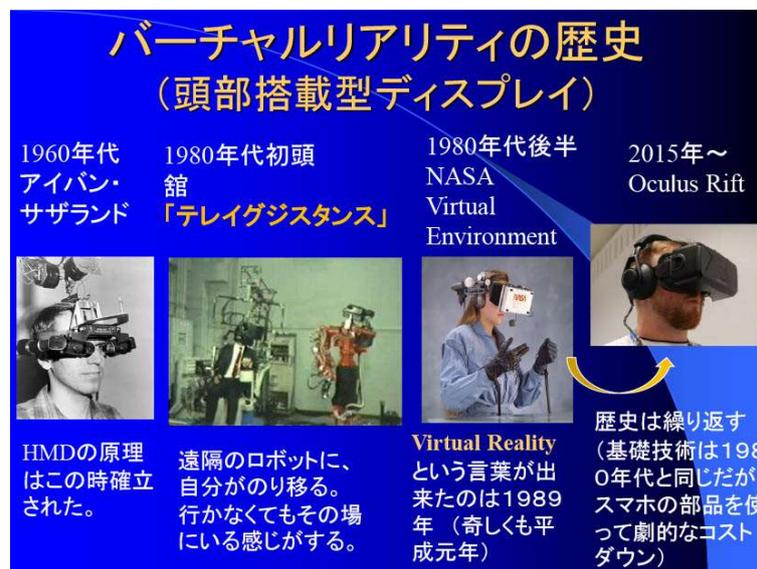
図 1 の 1 番左の写真。1960 年代は CG の研究が進んだ期間だ。ヘッドマンディスプレイ (以下 HMD) と呼ばれる機器を装着している。両目にそれぞれ異なるブラウン管を搭載し、左右の目に少しずつれた絵を提示することで、脳が立体的に感じる仕組みだ。頭上の装置は角度を計測するもので、被験者がどの方向を向いているかを感知し、頭を向けた方向の映像を提示できる。CG の生みの親として有名な Ivan Edward Sutherland 氏が開発したこの HMD が、現在の VR のルーツとなっている。
